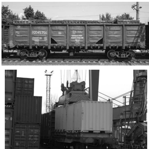
Рис. 2. Перевозка в полувагоне среднетоннажных контейнеров, списанных в 2013 году, и перевозка на фитинговой платформе среднетоннажных модулей с контейнер-адаптером в 2023 году.
