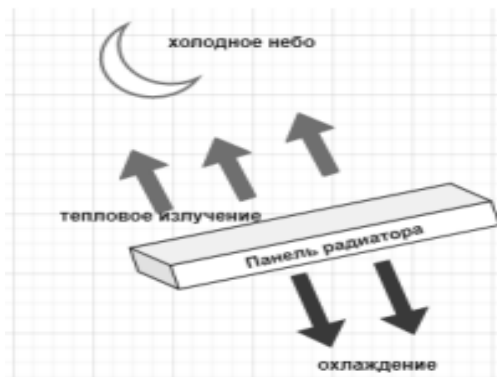
Рис. 3. Схема радиатора ночного пассивного радиационного охлаждения [2]
