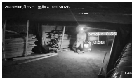
Рис. 3. Обнаружение дыма и пожара.
