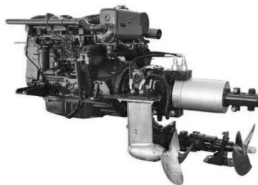
Рис.2 Система силовой установки для судна Hedropack [7]
